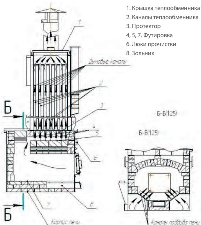
Установка пригодна и для воздушного отопления производственных помещений
